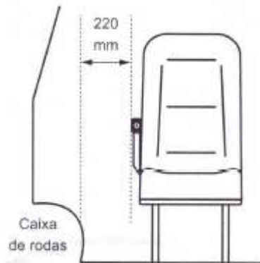
Figura 15 - Espaçamento entre poltrona e caixa de rodas
