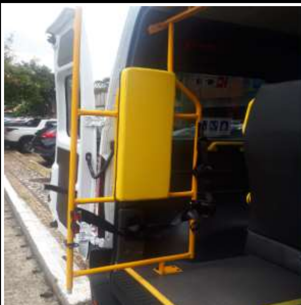
Guarda corpo na traseira do veículo com sistema de abertura móvel para permitir a saída dos passageiros
