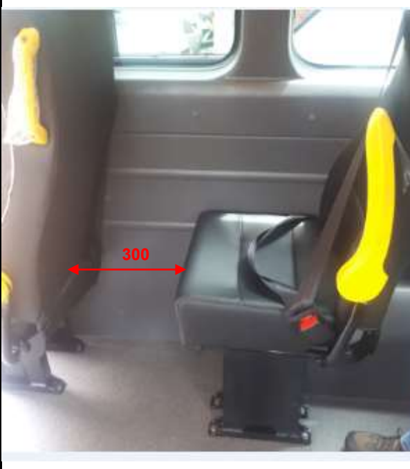
Espaçamento ente bancos mínimo 300 mm
